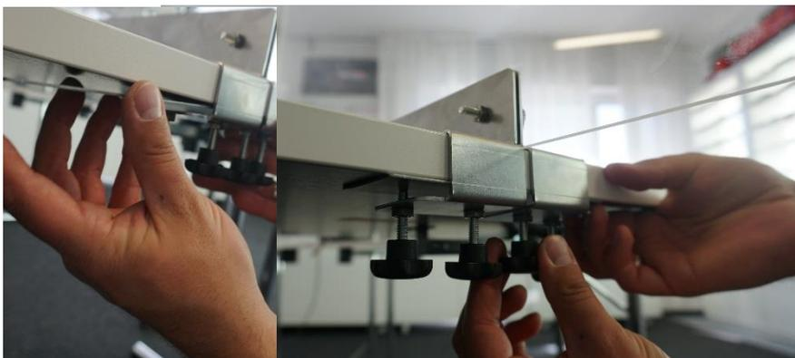
3. Als nächstes schieben Sie die beiliegende Metallplatte in den Zwischenraum von Tischplatte zu Metallprofilen. Das schützt den Tisch vor eventuellen Beschädigungen durch die Montage. Positionieren Sie die Schutzwand an gewünschter Stelle am Tisch. Die Winkelung sollte dabei direkt an der Kante der Tischplatte anliegen.
