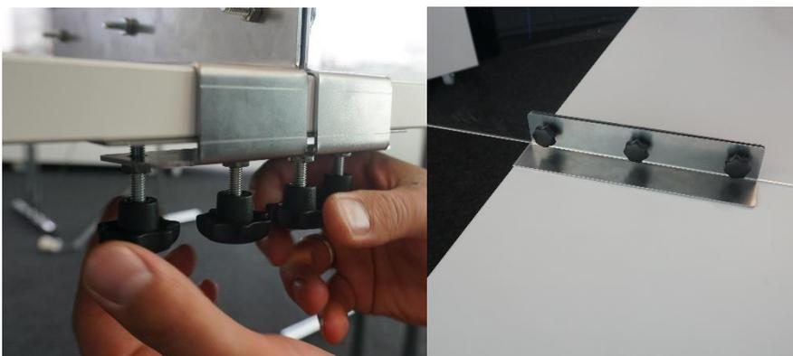
4. Zum Schluss werden die Schrauben unter dem Tisch (alle vier) bis zum ersten Kontakt mit der Tischplatte festgezogen, anschließend pro Schraube eine Viertelumdrehung. Die Profilplatte biegt sich leicht nach unten durch. Es wird kein zusätzliches Werkzeug dafür benötigt. Die Schutzwand ist nun stabil angebracht und einsatzbereit. Vielen Dank für Ihren Einkauf, bleiben Sie gesund!
