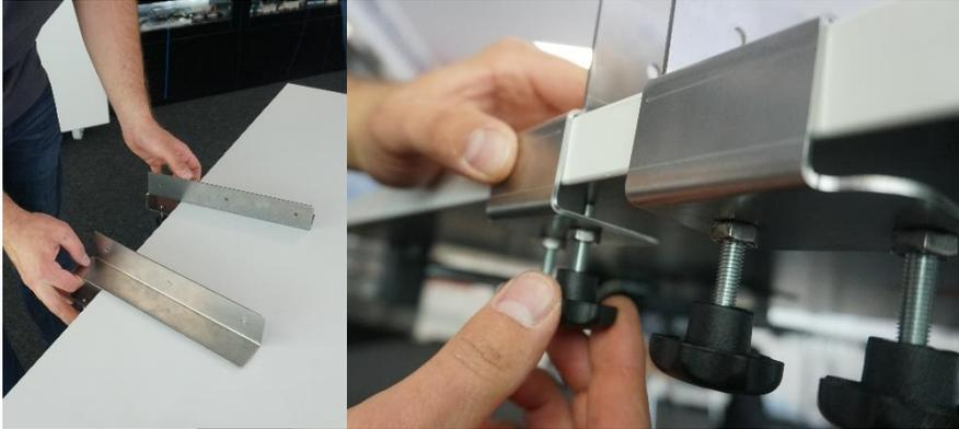
1. Legen Sie die beiden Metallprofile nebeneinander auf den Tisch, sodass die Winkel die Tischkante umfassen und der Abstand zueinander ungefähr der Dicke der Schutzwand entspricht. Anschließend müssen die Winkel mit den Schrauben von unten leicht am Tisch fixiert werden.
