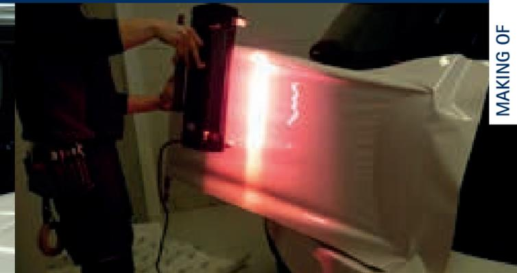
Durch das KNIFELESS-Band vermeiden wir das Schneiden am Lack. Das erhöht zwar die Gesamtkosten, jedoch haben Sie keine Schnitte im Lack und keinen Ärger, wenn Sie die Folie wieder entfernen. Zum Schluss werden alle Anbauteile wieder montiert.
